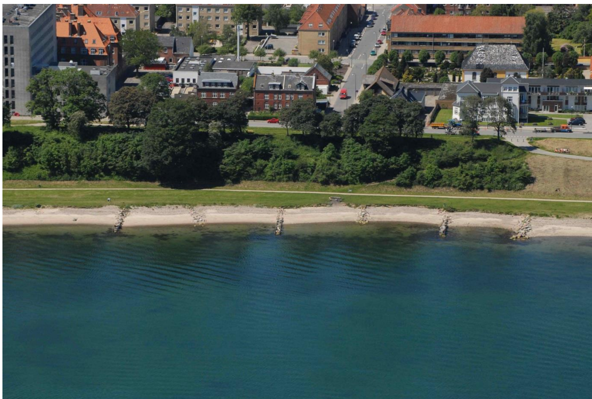
Figur 5 Udsnit af hofdegruppe på Østerstranden. Man ser resterne af de fjernede hofder.
