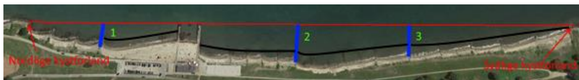
Figur 17: Optimal forøgelse af strandbredde via sandfodring. Den sorte linje illustrerer kystlinjens placering efter sandfodring.
