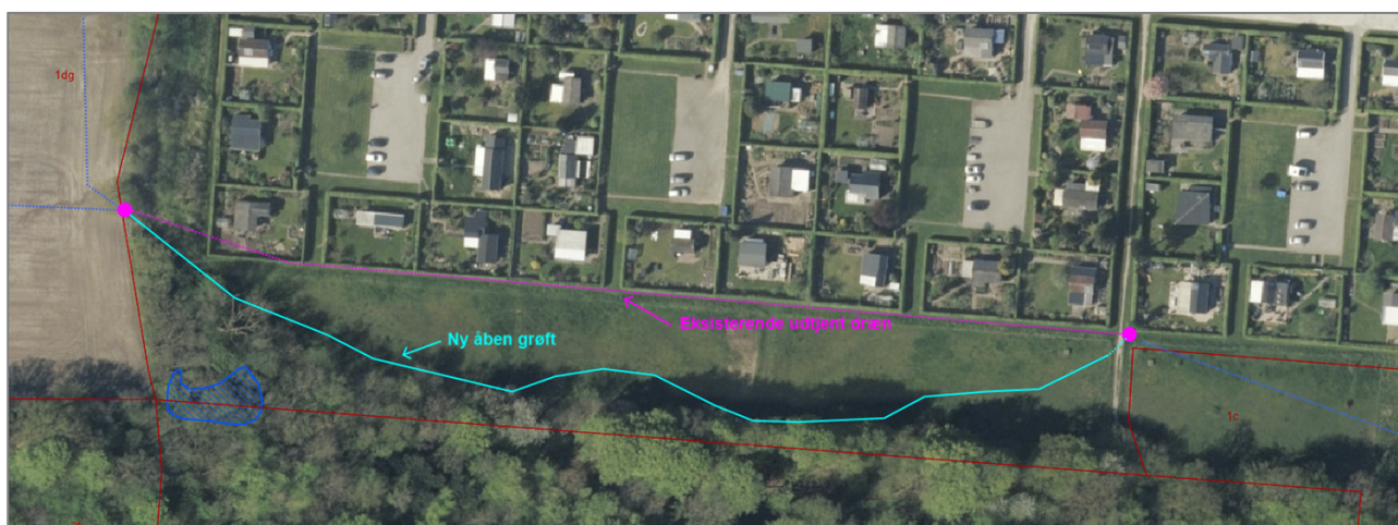
Figur 1: Oversigtskort med angivelse af placering af eksisterende lerdræn og ny åben grøft.
