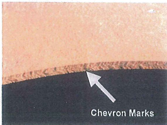
Figur 38: Eksempel på Chevron marks. Kilde: www.metallurgist.com
