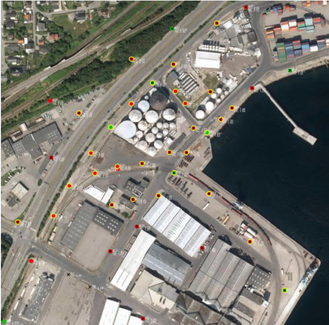
Figur 7.2 Situationsplan med boringsplacering. Boringer markeret med gul ring angiver de boringer, der har indgået i nærværende undersøgelse.
