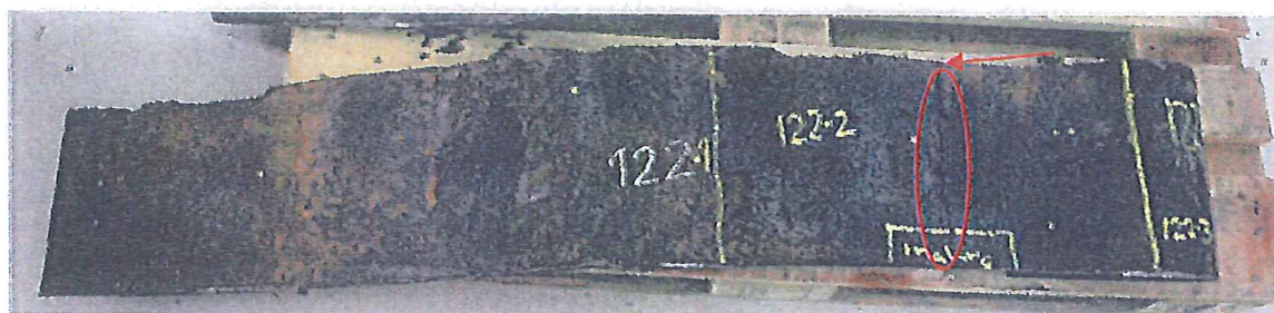
Figur 24 Plade 122 oversigtsbillede. Svejsning og brudstart markeret med henholdsvis cirkel og pil
