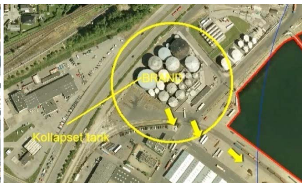
Figur 4.5 Udstrømning af N-16 fra tank 1-3.
