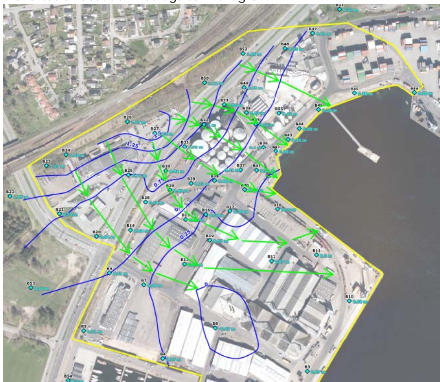
Figur 8.8 Potentialekort for grundvandet (grønne pile angiver strømningsretning).
