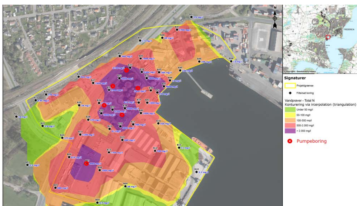
Figur 11.1 Illustration af forventede placeringer af pumpeboringer.
