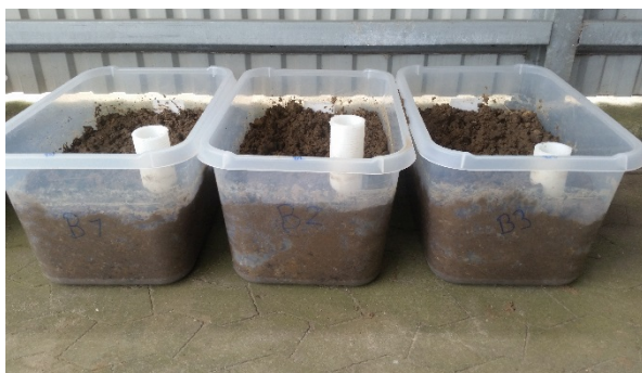
Figur 7.1 Foto af forsøgsopstilling B1-B3 (N-16 gødning) med filterrør
