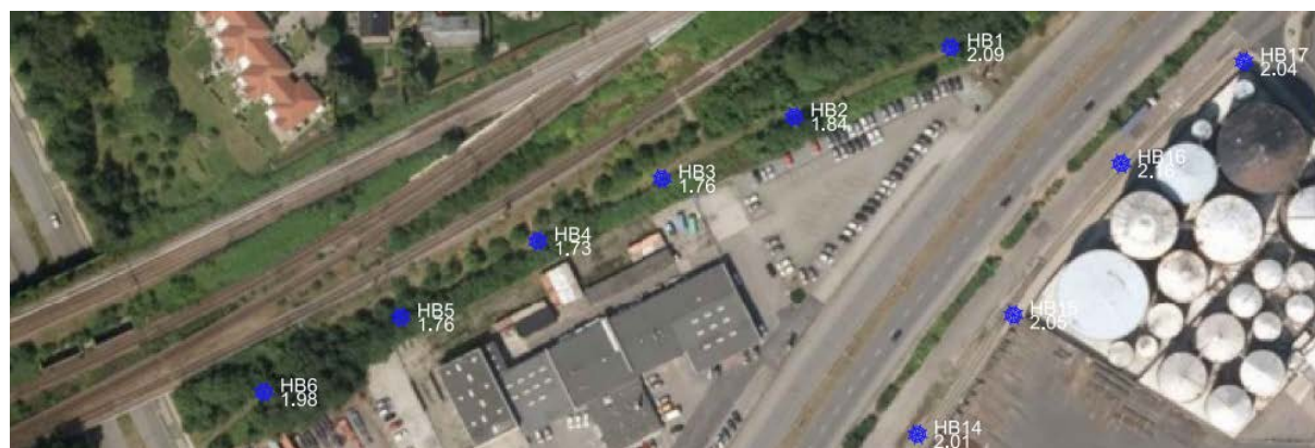
Figur 8.2 Kortudsnit over grøften med placering af bl.a. håndboring HB1-HB6.
