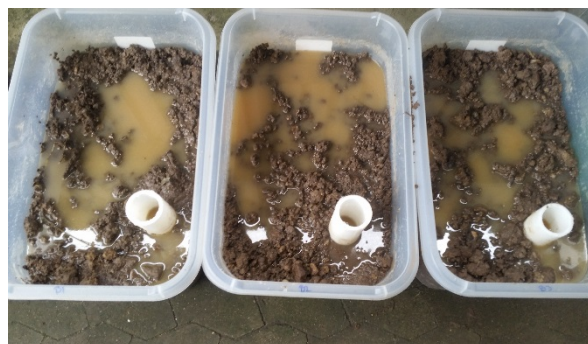
Figur 7.2 Mætning af batter og jord med gødningsvand (A1-A3).
