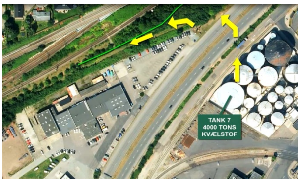
Figur 4.4 Udstrømning af N-32 fra tank 7.
