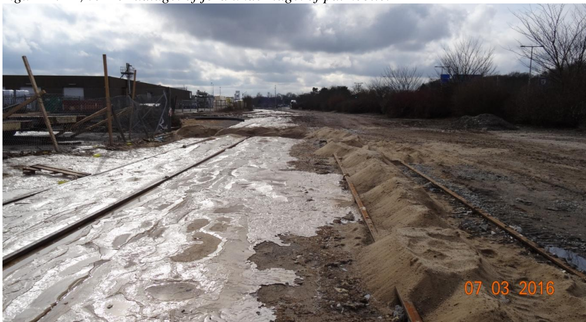
Figur 12. Området mellem sporareal og Bitumenvej hvor prøve 4 er udtaget under laget af palmeolie.
