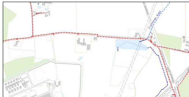
Regnvandsbassin i nordøst udleder til Tranekær Bæk
