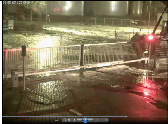
Overfladeafstrømningen er så voldsom, at kun begrænsede mængder gødning vil kunne nå at løbe i rendestensbrønde, langt størstedelen løber forbi. Der er gået 30 sekunder fra gødningen først registreres.
