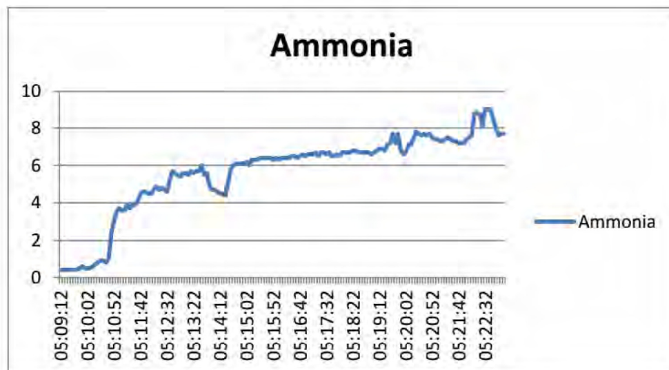
Figur 7.7: Resultat af luftmålinger den 26. marts 2016 udført af Arbejdsmiljøeksperten (mg/m³).
