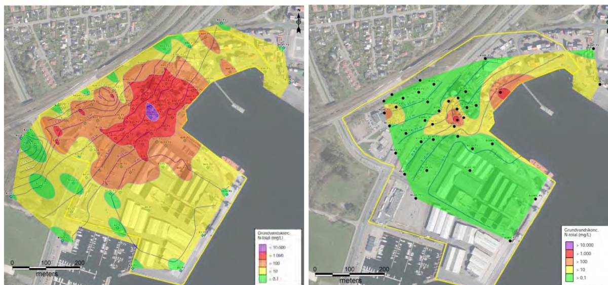
Figur 9.5 Kontureringsplot fra Surfer med total-N (mg/kg TS) for max. koncentrationer i borerne (tv) og koncentrationer i nedre del (th) af grundvandsmagasinet.
