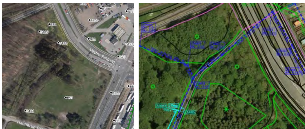
Figur 9.8 Boringer i området vest for Vestre Ringvej og kort med placering af regnvandsledning.
