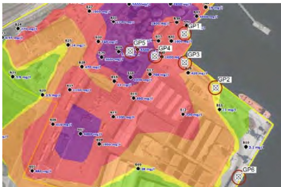
Figur 8.15 Placering af seks geoprobeboringer (GP1-GP6) udført af NIRAS.
