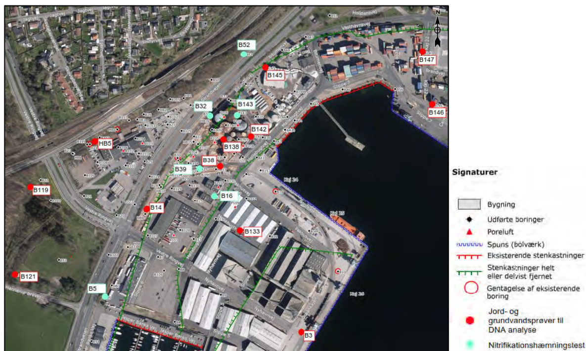
Figur 7.9 Boringer hvor der er udtaget jord- og grundvandsprøver til DNA sekventering og nitrifikationshæmningstest.
