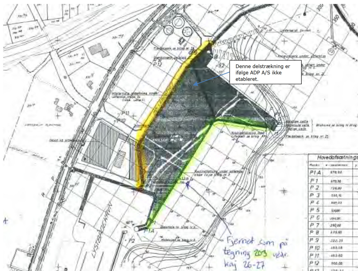
Figur 8.8 Helt eller delvist fjernede stenkastninger på indvundet havneareal.
