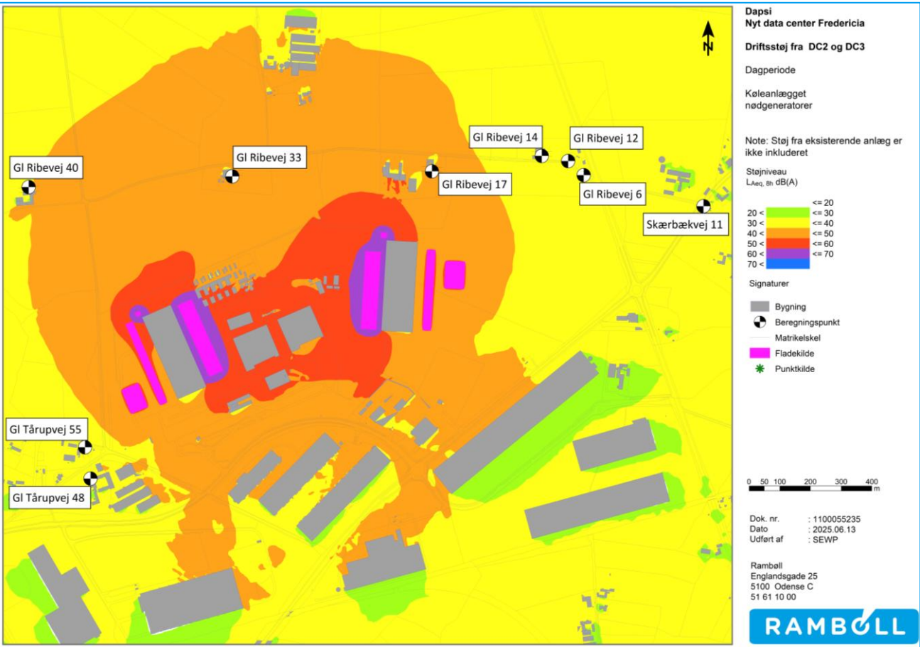
Figur 1-11 - Støjudbredelse driftsstøj efter opførelse af DC2 og DC3 - dagsituation. Test af Køleanlægget nødgeneratore. Støjudbredelsen fra det eksisterende anlæg ved DAPSI er ikke medtaget i denne beregning af støjudbredelsen.
