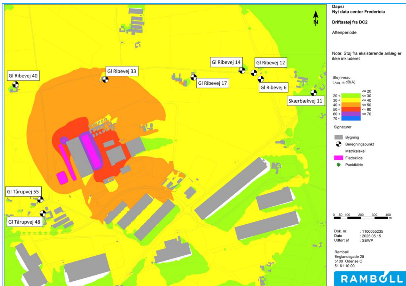
Figur 1-3 - Støjdbredelse driftsstøj efter opførelse af DC2 - aftensituation. Uden test af nødgeneratorer. Støjdbredelsen fra det eksisterende anlæg ved DAPSI er ikke medtaget i denne beregning af støjdbredelsen.
