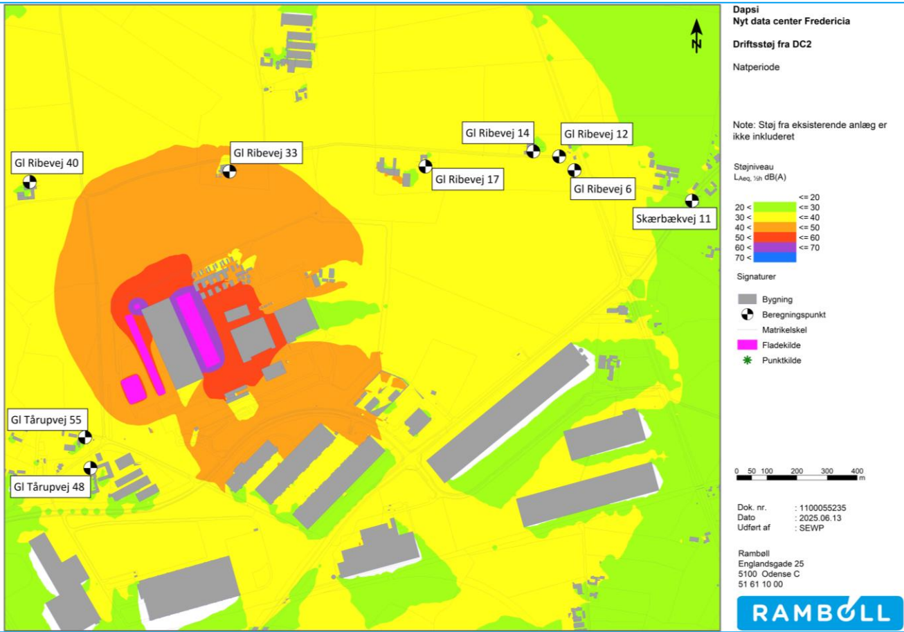
Figur 1-7 Støjdbredelse driftsstøj efter opførelse af DC2 - natsituation. Uden test af nødgeneratorer. Støjdbredelsen fra det eksisterende anlæg ved DAPSI er ikke medtaget i denne beregning af støjdbredelsen.
