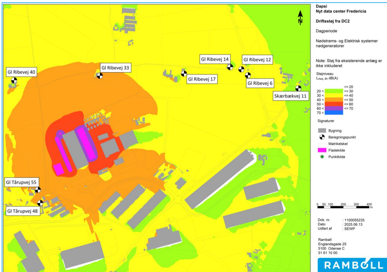
Figur 1-2 - Støjudbredelse driftsstøj efter opførelse af DC2 - dagsituation. Test af Nødstrøms- og Elektrisk systemer nødgeneratore. Støjudbredelsen fra det eksisterende anlæg ved DAPSI er ikke medtaget i denne beregning af støjudbredelsen.
