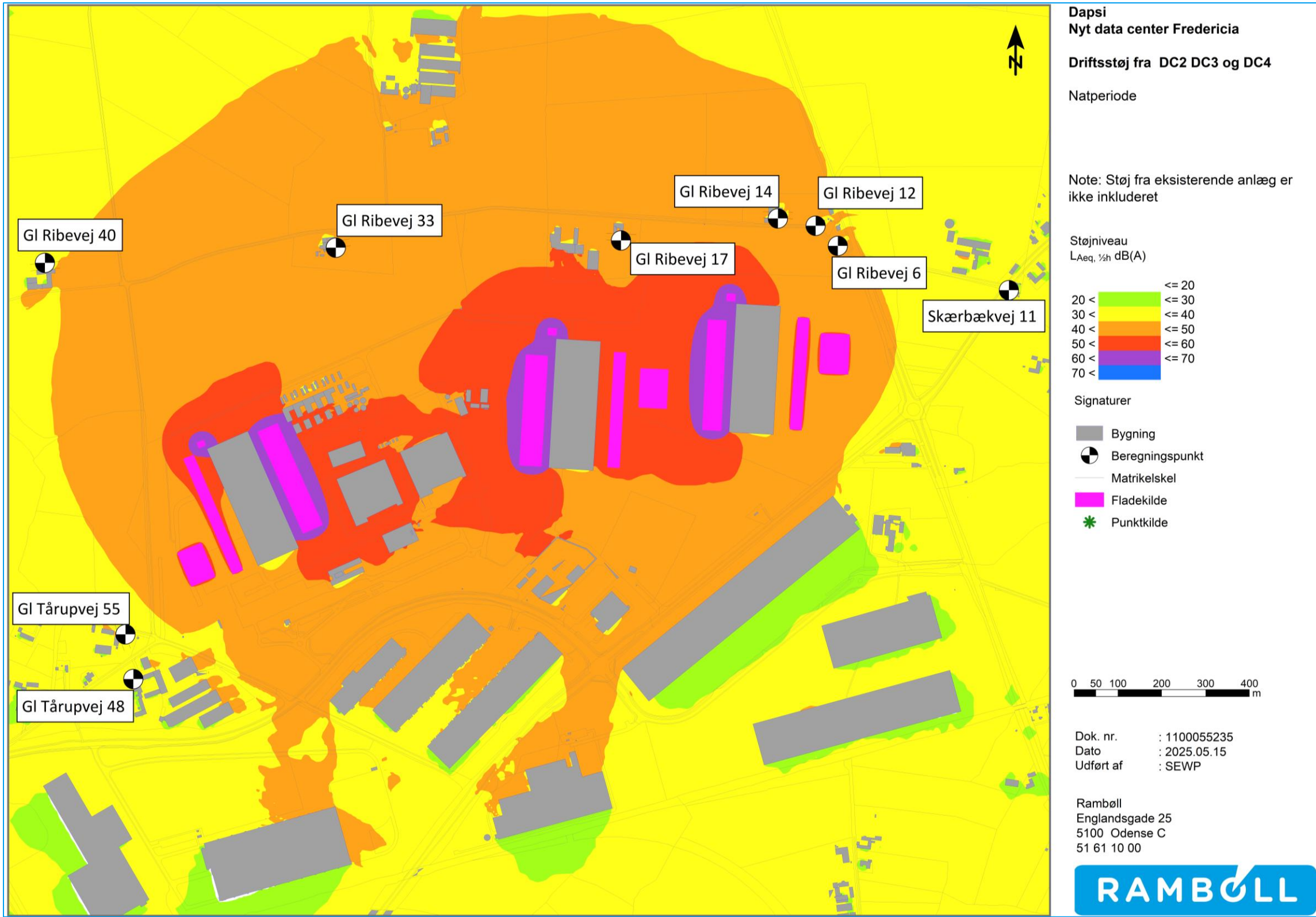
Figur 1-37 - Støjudbredelse driftsstøj efter opførelse af DC2, DC3 og DC4 - natsituation. Uden test af nødgeneratorer. Støjudbredelsen fra det eksisterende anlæg ved DAPSI er ikke medtaget i denne beregning af støjudbredelsen.
