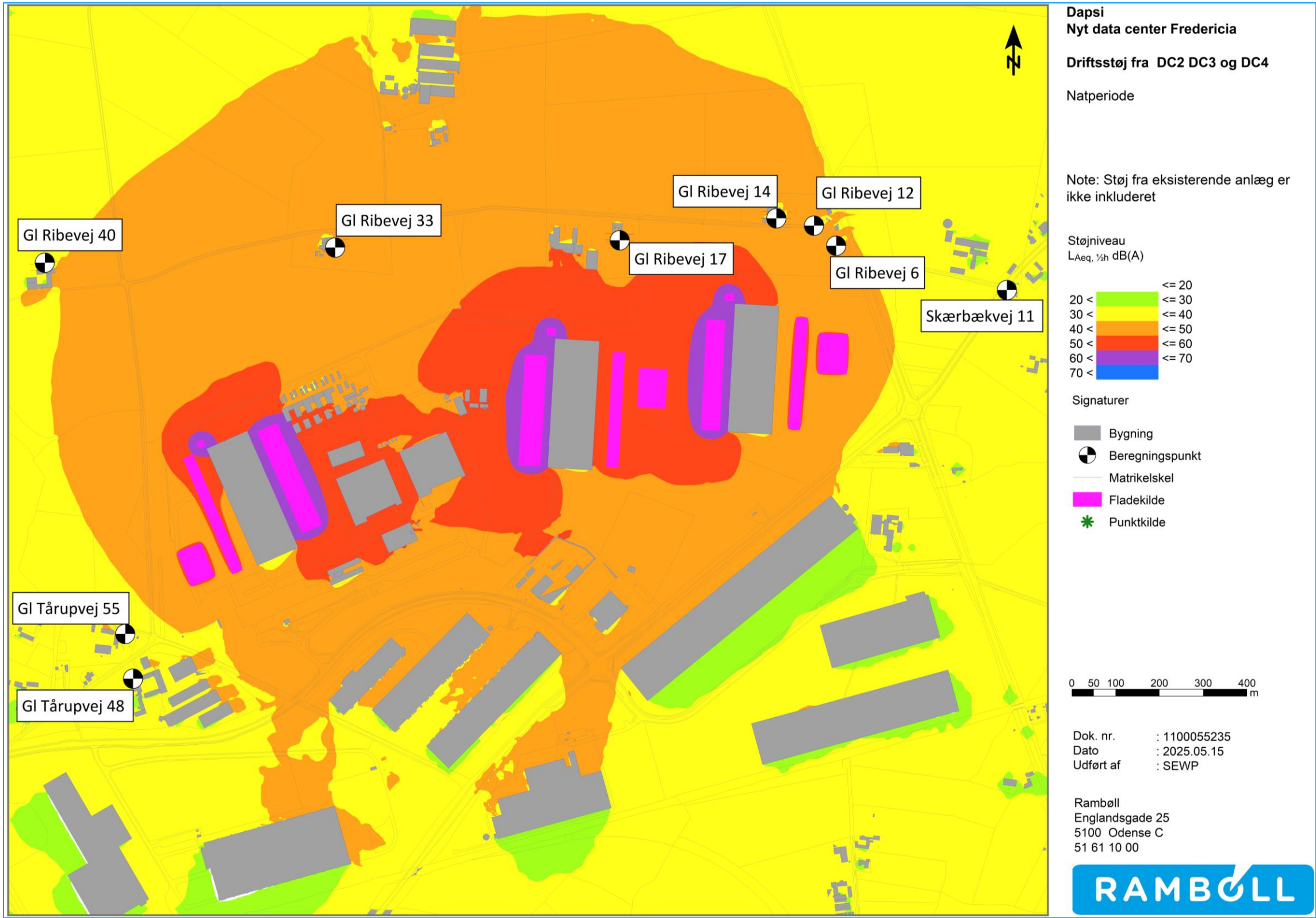
Figur 1-40 - Støjudbredelse driftsstøj efter opførelse af DC2, DC3 og DC4 - natsituation. Uden test af nødgeneratorer. Støjudbredelsen fra det eksisterende anlæg ved DAPSI er ikke medtaget i denne beregning af støjudbredelsen.
