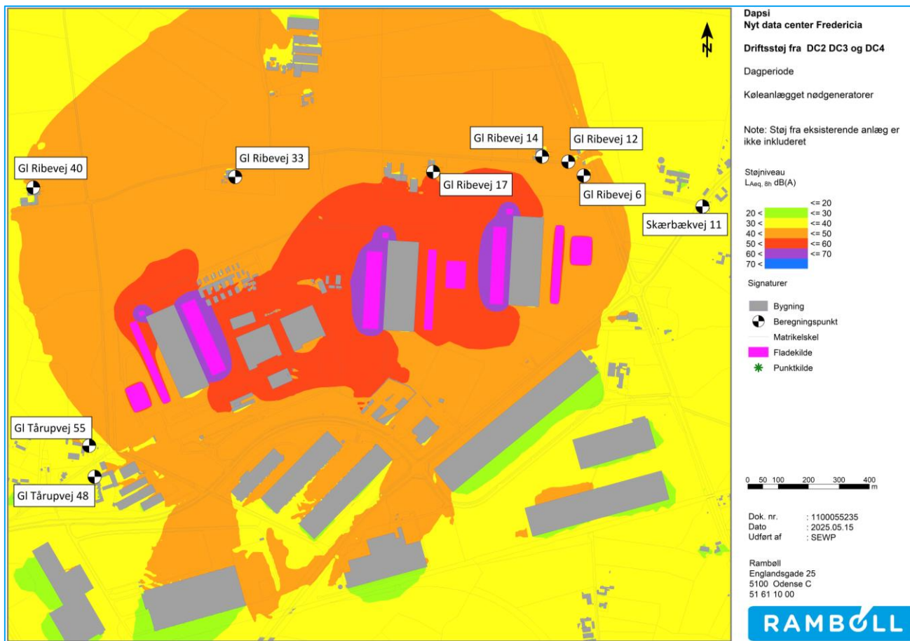
Figur 1-17 - Støjudbredelse driftsstøj efter opførelse af DC2, DC3 og DC4 - dagsituation. Test af Køleanlægget nødgeneratorer. Støjudbredelsen fra det eksisterende anlæg ved DAPSI er ikke medtaget i denne beregning af støjudbredelsen.
