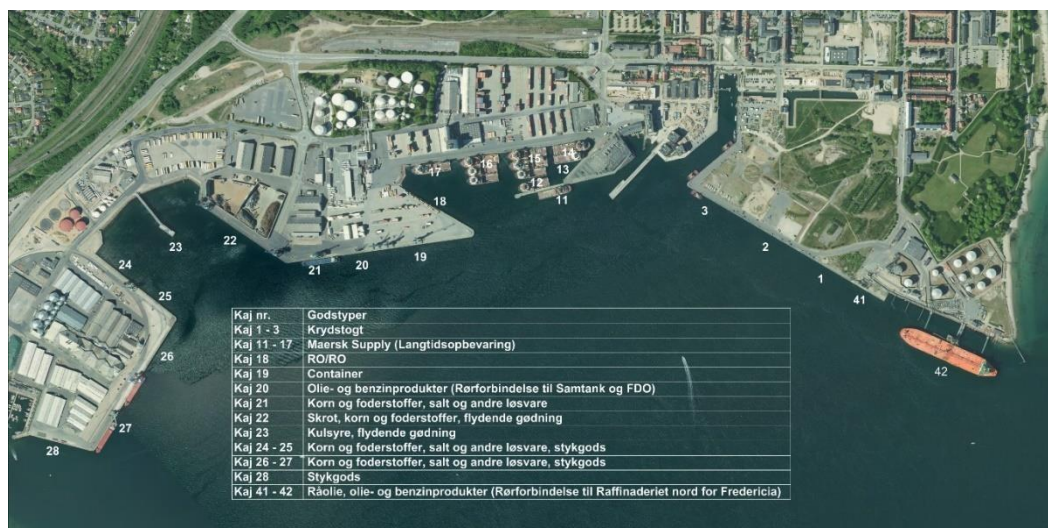
Figur 1-1: Eksisterende forhold med kaj nummerering.
