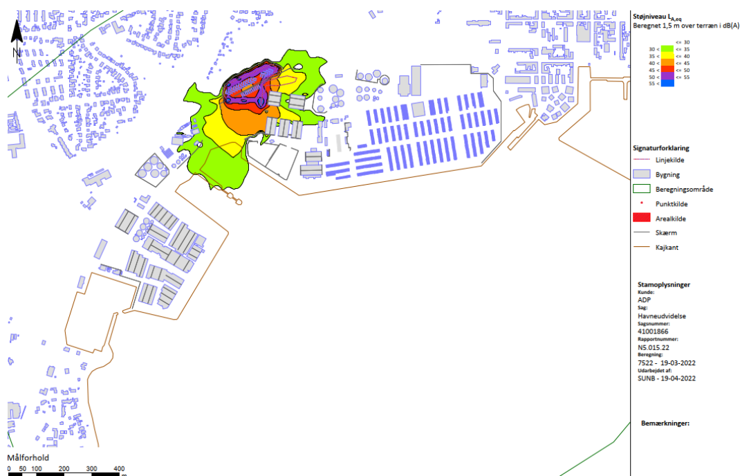
Figur 12-25: Støjudbredelsesforhold ved driftsfasen uden skibsanløb, 1,5 m over terræn. Hverdag, nat (kl. 22-07), Kaj 23. De grønne farver viser områder, som overholder vejledende støjgrænser for åben og lav boligbebyggelse, mens de gule farver viser områder, der overholder støjgrænserne for centerområde. Samme kort findes i Bilag 5 i høj opløsning, hvor det er muligt at studere de nærmere detaljer.
